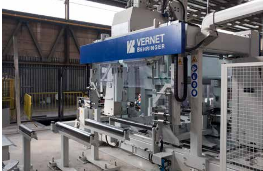
Met de nieuwe boorzaakstraat van Vernet Behringer wil CSM evolueren naar een meer lijngeoriënteerde productie.
