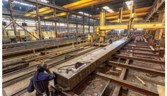
(Door)lassingen krijgen extern magnetisch en ultrasoon onderzoek.
