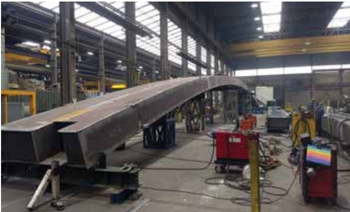
Opstelling met middenboog (drie segmenten) volledig gemonteerd.
